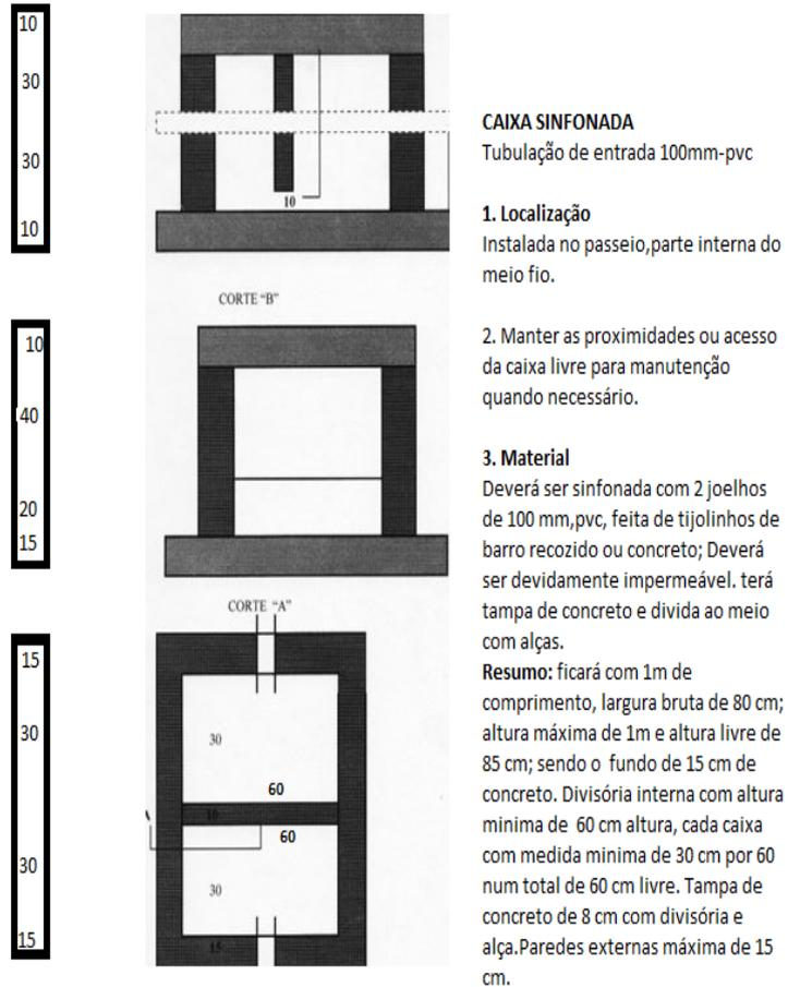
*Figura 2 – Modelo de Caixa de Inspeção*
